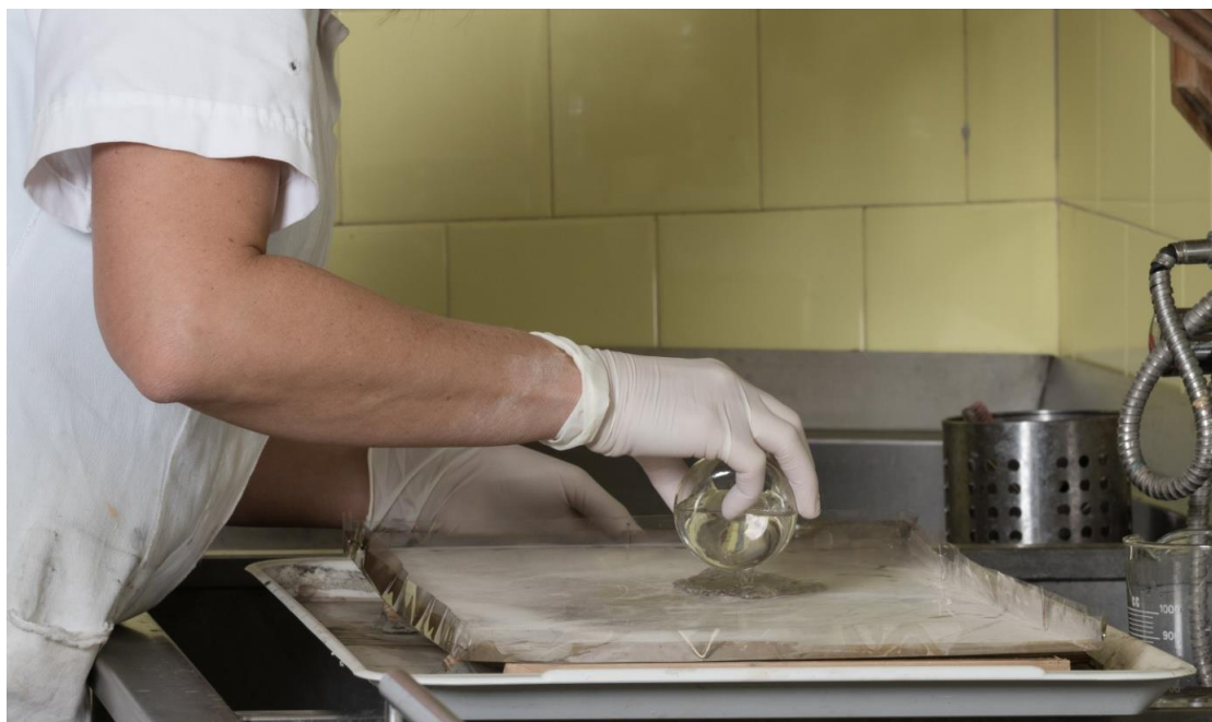
Foncsorozás: ezüstoldat öntése a felületre
