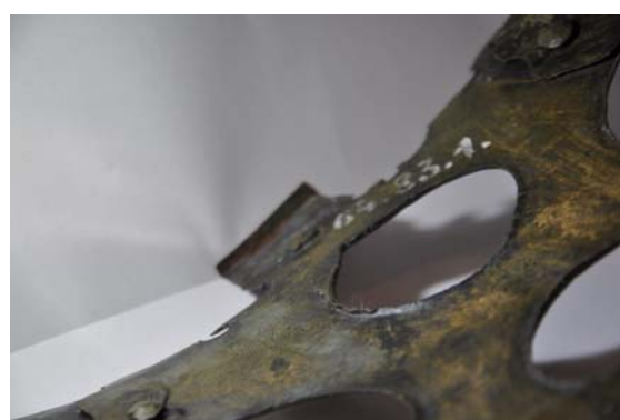
9. ábra: A hátlapra kalapált sorja az A-II elemen
