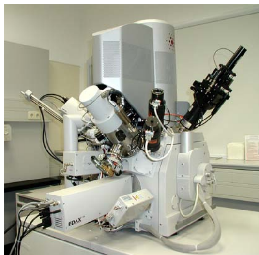
1. ábra: Az ELTE TTK Quanta 3D kétsugaras pásztázó elektronmikroszkópja
