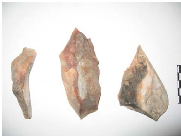
6. ábra: A hőkezelés során a mintadarabokról levált, különböző méretű és formájú szilánkok
