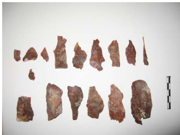
6. ábra: A hőkezelés során a mintadarabokról levált, különböző méretű és formájú szilánkok
