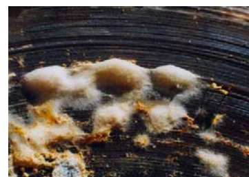
2. kép: Fertőzött archív filmanyag ( Aspergillus , Penicillium , Mucor , Cladosporium és Trichoderma penészgomba fajok)
